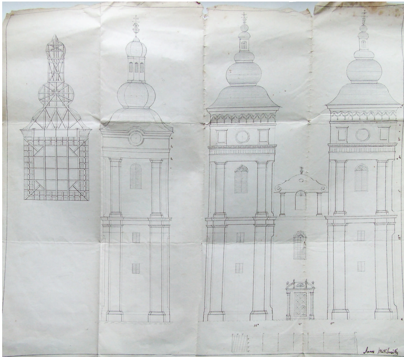
27. A máriapócsi kegytemplom tornyainak magasítási terve, 1855. NBRML (jelzet nélkül) – Fotó: Terdik Szilveszter
